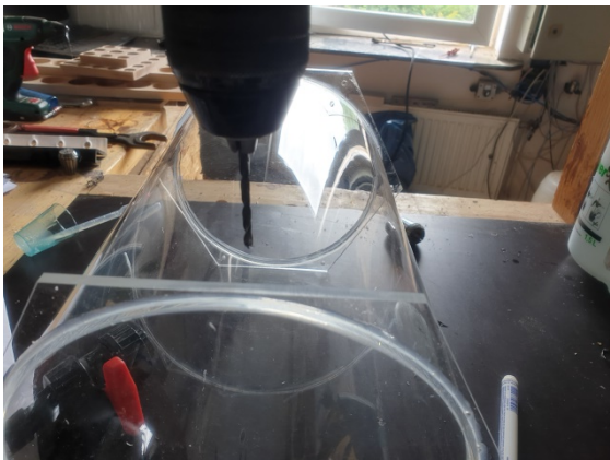
Loch in den Zylinder, da läuft später (hoffentlich) das flüssige Gold durch.
