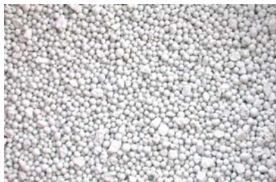
Durch Verwendung eines Spezialgranulats (AquaCare Turbo-Granulat) kann die Leistung eines jeden Kalkreaktors erhöht werden. Bild: AquaCare
