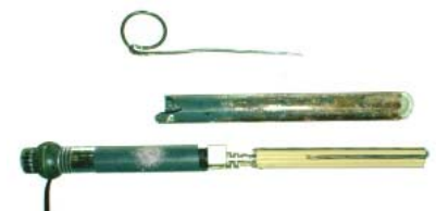
... wird letztendlich zerstört. Ohne FI-Schalter kann das den Tod für den Aquarianer bedeuten.
