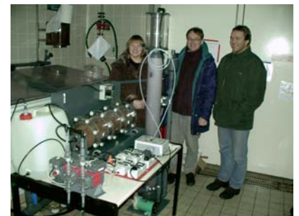
Versuchs-Denitrifikationsfilter bei 0°C im Alfred-Wegener-Institut für Polarforschung.
