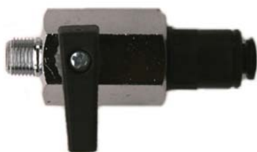
Minikugelhahn mit eingebauter Blende: im geschlossenen Zustand fließt Wasser durch die Blende, im offenen fließt viel Wasser zum Spülen.
